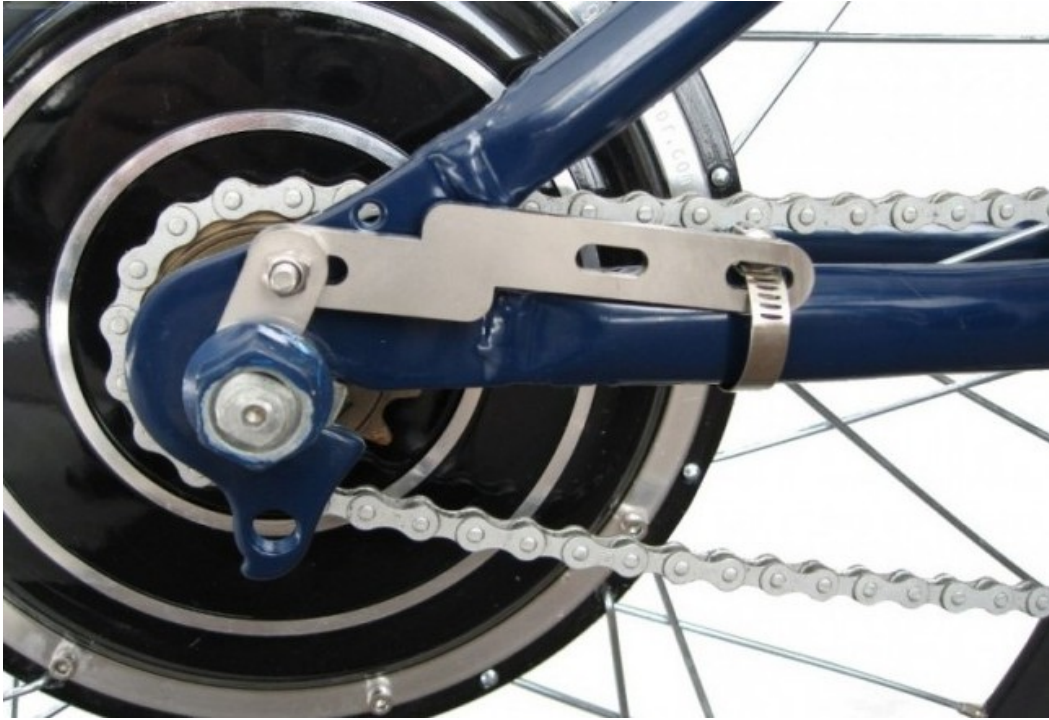
Exemple avec un torque arm au niveau de la roue arrière.
