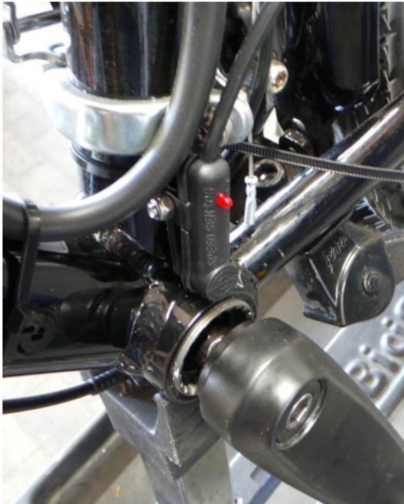
Si l'espace entre le disque et le cadre est trop fin, vous pouvez déporter le capteur **sous le cadre** et le coller à l'aide d'un pàton de pâte bi-composant.
