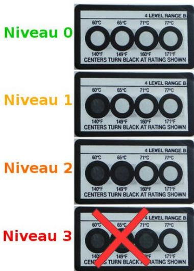
**Niveau 0** : aucun rond n'est noirci. La température extérieure du contrôleur est de moins de 60°C. Le matériel est utilisé de façon normale, en bon père de famille, pas de risque de surchauffe.
