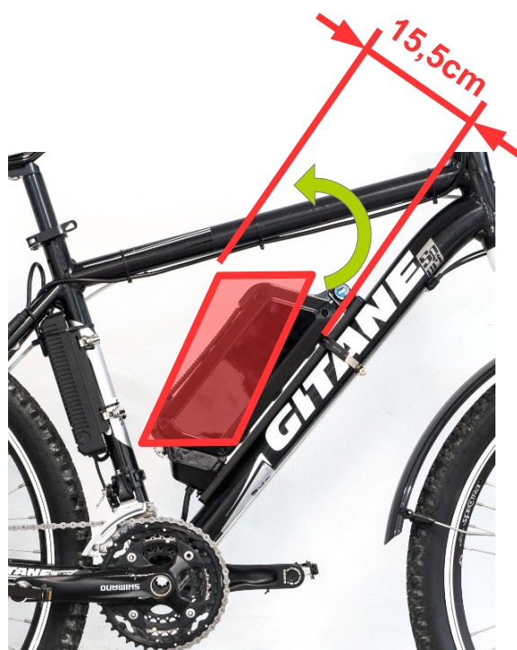
Dimension hors tout nécessaire pour pouvoir retirer la batterie de sa platine
